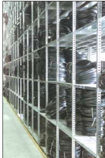
Traversos kabinamos prie stovų. Ant traversų dedami lentynų segmentai.
